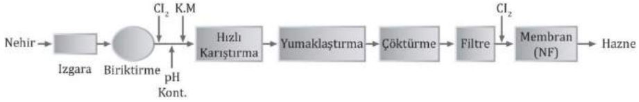
Şekil 8.13 Çökebilir madde miktarı ve organik madde muhtevası yüksek ve mevsimlere göre kil muhtevası ve rengi değişen nehir suları
