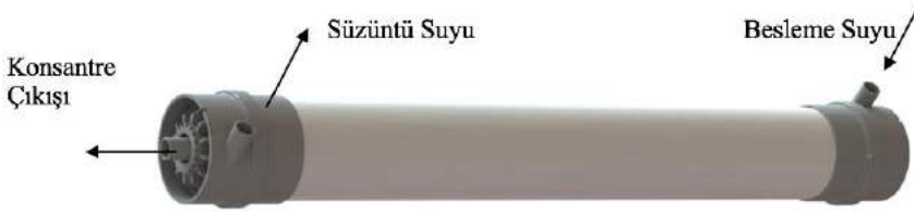
Şekil 6.6 Çapraz akışlı çalışan bir içi boşluklu fiber membran modülü (GEN UF, 2017)
