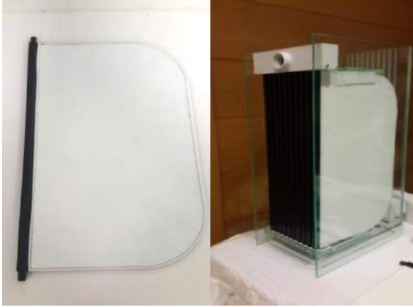
Şekil 6.4 a) Plastik çerçeveye yapıştırılmış düz plaka membrandan oluşan plak-çerçeve modül b) bu kasetlerin bir araya getirilmesiyle oluşturulan modül (MEM-TEK Kütüphanesi)
