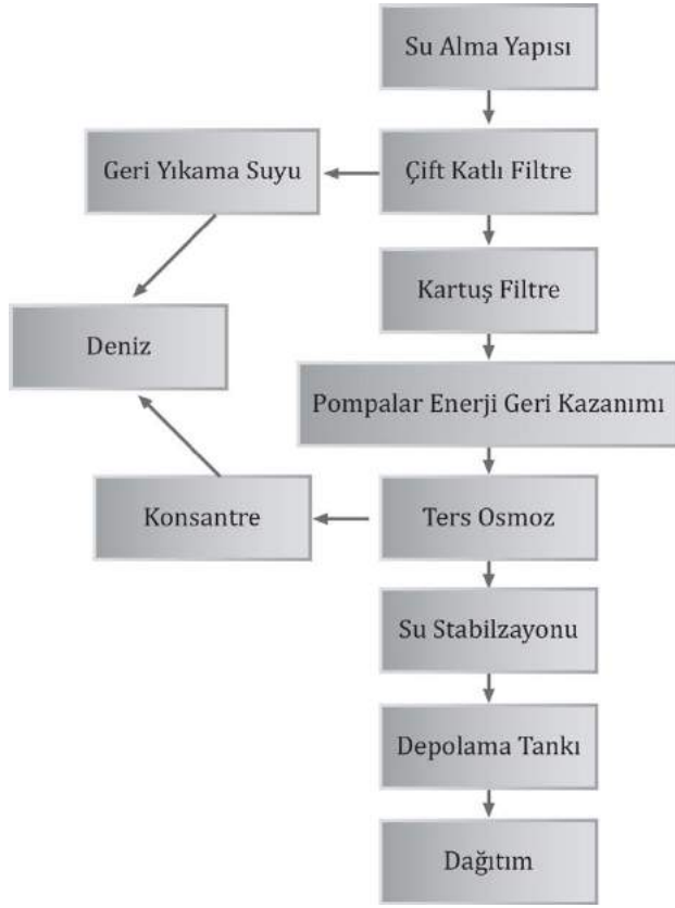
Şekil 7.84 Tesisin basitleştirilmiş akım şeması
