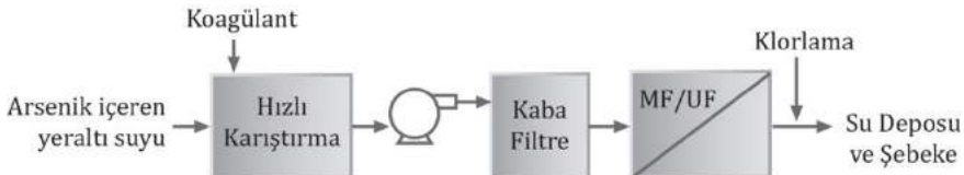
Şekil 7.23 Yeraltı suyundan arsenik giderimi için kullanılan düşük basınçlı membran sistemlerinin basit bir gösterimi (AWWA, 2005)
